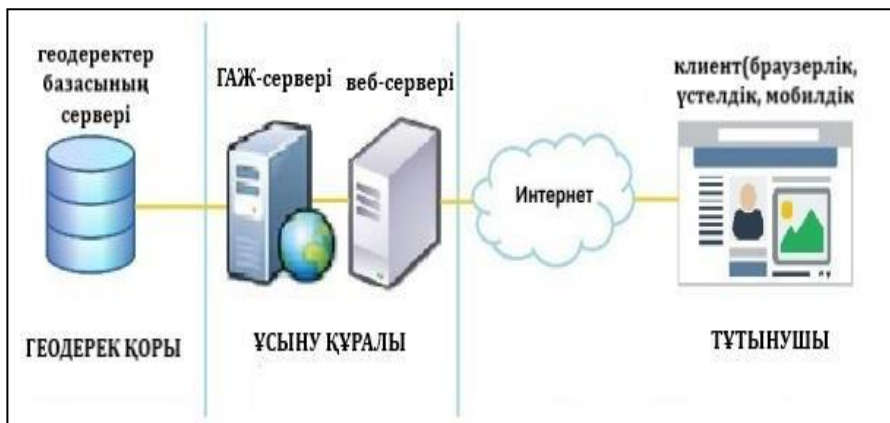
18-сурет. ГАЗ сервері қызметінің қарапайым құрылымы
